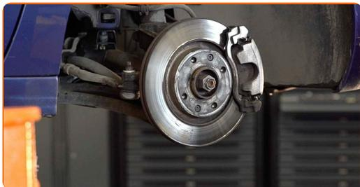
**13** Koble ledningene og bremseslangen fra braketten på fjærbeinet.
