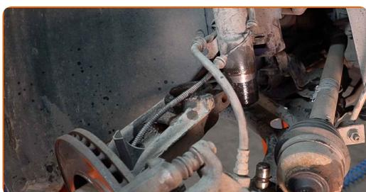
**31** Koble styrespindelen fra fjærbeinet. Bruk en gummihammer.
