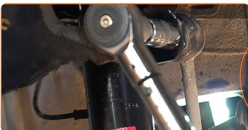
**67** Fest bremseslangen på beinet. Koble ABS-sensorkabelens lås til fjærbeinet.
