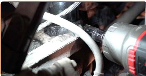
**58** Skru fast festet som kobler kulleleddet til styrespindelen. Bruk en pipenøkkelinnsats #16. Bruk en pipenøkkelinnsats #18. Bruk en skrallenøkkel.
