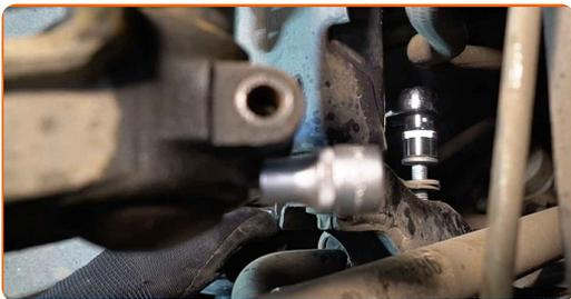
**21** Rengjør festet som kobler kuleledd til styrespindel. Bruk en stålbørste. Bruk WD-40 spray.
