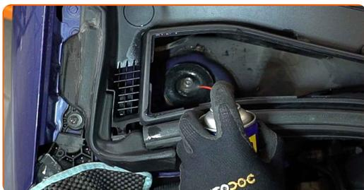
**6** Løsne det øverste festet på fjærbeinets montering. Bruk en pipenøkkelinnsats #21. Bruk HEX nr. H7. Bruk en skrallenøkkel.
