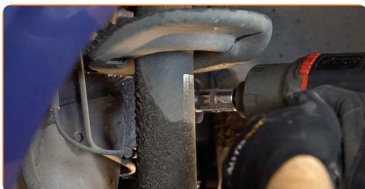
**16** Rengjør festene som kobler fjærbein til styrespindel. Bruk en stålbørste. Bruk WD-40 spray.
