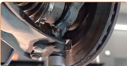
**59** Skru inn festet som forbinder fjærbeinet med styrespindelen. Bruk en pipenøkkelinnsats #18.
