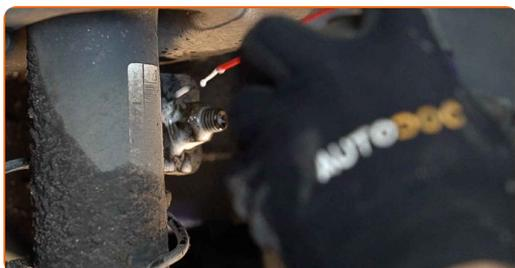
**15** Skru løs mutteren og fjern stabilisatorstangen fra fjærbeinet. Bruk en pipenøkkelinnsats #16.
