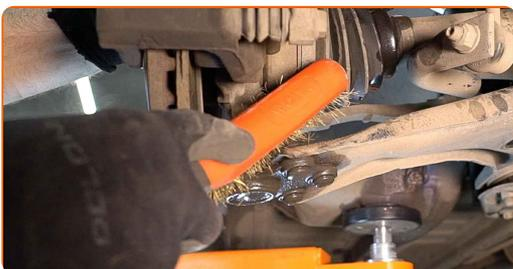
**22** Skru kuleleddfestet til styrespindelen. Bruk en pipenøkkelinnsats #E8. Bruk en pipenøkkelinnsats #18. Bruk en skrallenøkkel.
