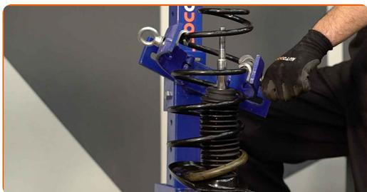
**42** Installer den øvre demperen og monteringslager.
