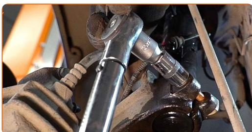
**65** Stram kuleleddfestet. Bruk en pipenøkkelinnsats #16. Bruk en momentnøkkel. Stram den til 40 Nm dreiemoment.
