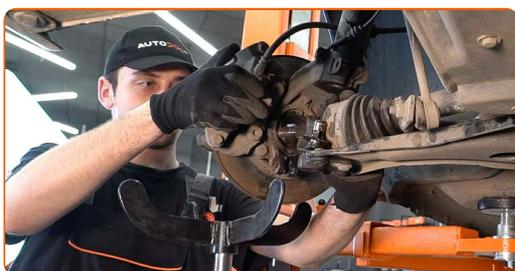
**30** Frigjør nedre feste som kobler fjærbein til styrespindel. Bruk en spesiell pipenøkkel til å fjerne støtdemperen. Bruk en skrallenøkkel.
