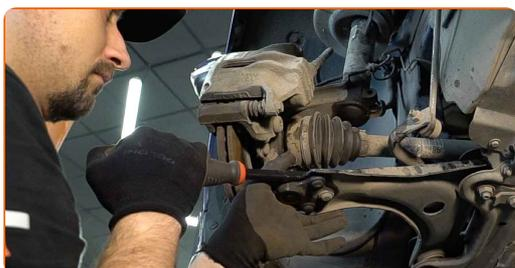
**28** Løft opp styrespindelen. Bruk en hydraulisk jekk.
