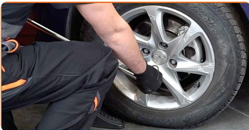
**9** Løsne festet til drivakselen. Bruk en pipenøkkelinnsats #32. Bruk et svingjern.
