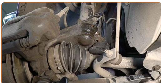
**20** Skru løs festene til stabilisatorstag forings brakettene. Bruk en pipenøkkelinnsats #18. Bruk en skrallenøkkel.
