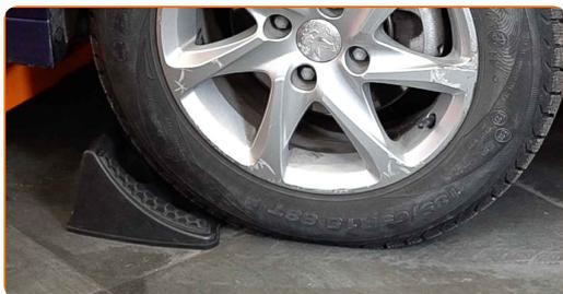
**8** Løsne hjulfesteboltene. Bruk en kraftpipe for hjulmutter #17.
