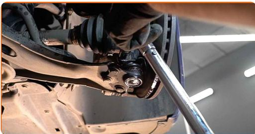
**66** Stram festene som kobler stabilisator-ledd til fjærbein. Bruk en pipenøkkelinnsats #16. Bruk en momentnøkkel. Stram den til 43 Nm dreiemoment.
