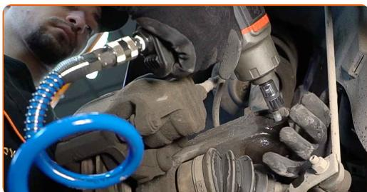
**18** Løft opp styrespindelen. Bruk en hydraulisk jekk.
