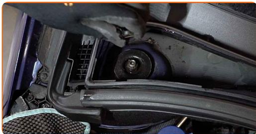
**5** Rengjør festene på fjærbeinets øvre sete. Bruk en stålbørste. Bruk WD-40 spray.
