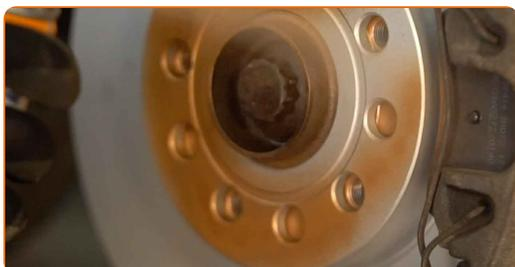
**15** Rengjør overflaten av bremseskiven. Bruk bremsrens.
