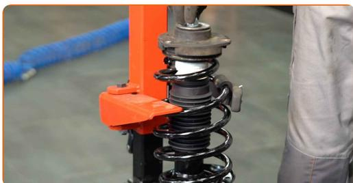
**44** Stram fjærbeinets stempelstangmutter. Bruk HEX nr. H6. Bruk en pipenøkkelinnsats #21. Bruk en momentnøkkel. Stram den til 60 Nm dreiemoment.
