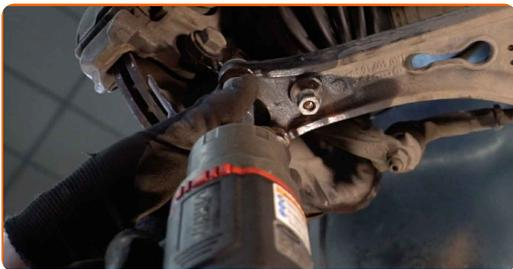
**58** Støtt armen. Bruk en hydraulisk jekk.
