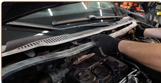
**75** Skru inn brettet til torpedoplaten under vindusviskeren. Bruk Torx T30.
