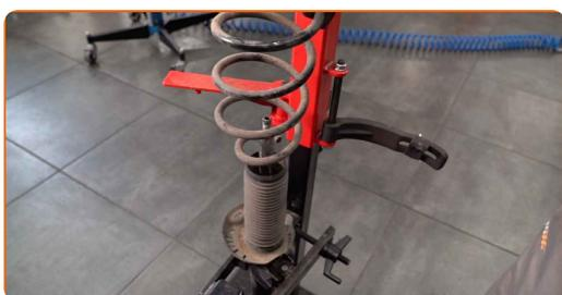
**39** Ta av støtdemper-støvhetten og støtstopperen.
