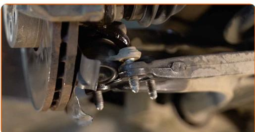
**57** Stram kuleleddfestet. Bruk en pipenøkkelinnsats #16. Bruk en momentnøkkel. Stram den til 60 Nm dreiemoment.
