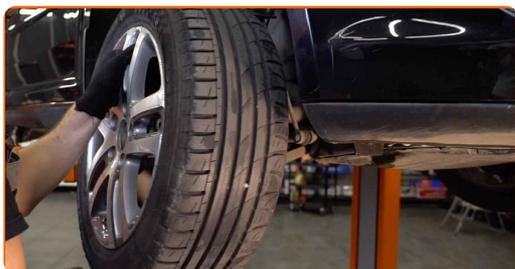
**14** Rengjør festene til stabilisatorleddet. Bruk en stålbørste. Bruk WD-40 spray.
