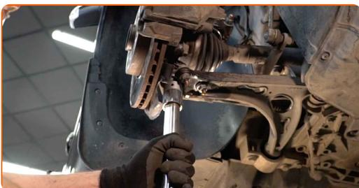
**59** Stram nedre fester som kobler fjærbein til styrespindel. Bruk en pipenøkkelinnsats #18. Bruk en momentnøkkel. Stram den til 70 Nm dreiemoment.+90°
