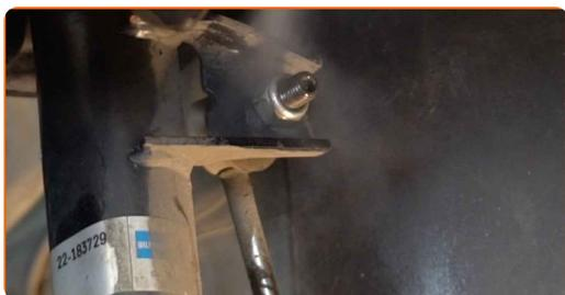
**15** Skru løs festene som kobler stabilisator-ledd til fjærbein. Bruk en pipenøkkelinnsats #19. Bruk en skrallenøkkel.
