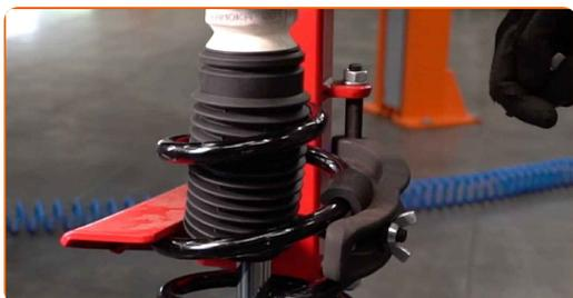
**43** Installer den øvre demperen og monteringslager.
