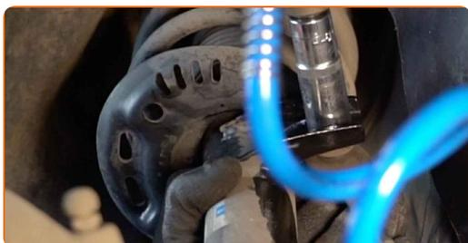
**16** Rengjør festebrakettene til bremseslangen. Bruk en stålbørste. Bruk WD-40 spray.
