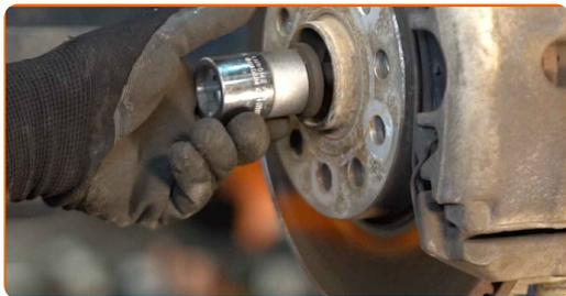
**22** Rengjør rillene på CV-leddet til drivakselen. Bruk WD-40 spray.
