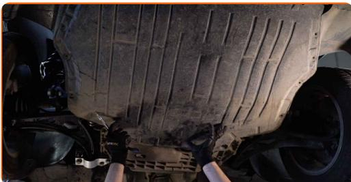
**19** Stram festene på oljesumpen nedre deksel. Bruk Torx T25. Bruk en skrallenøkkel.
