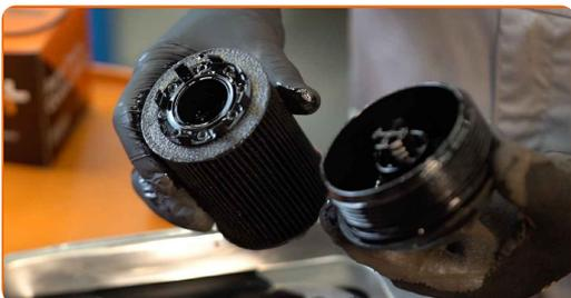
**23** Rengjør lokket til oljefilterhuset. Bruk universal rengjøringspray.
