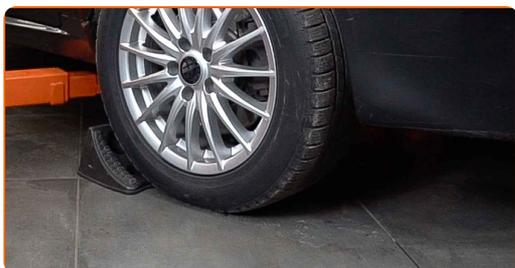
**6** Løsne hjulfesteboltene. Bruk en kraftpipe for hjulmutter #17.
