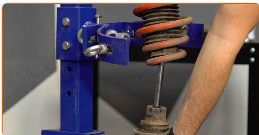
27 Ta av støtdemper-støvhetten og støtstopperen.
