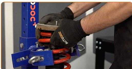
**34** Stram fjærbeinets stempelstangmutter. Bruk en kombinasjonsnøkkel #6. Bruk en kombinasjonsnøkkel #18. Bruk en pipenøkkelinnsats #18. Bruk en momentnøkkel. Stram den til 33 Nm dreiemoment.
