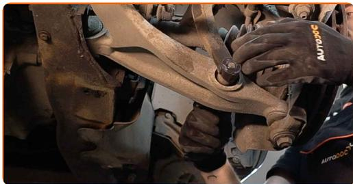
**16** Rengjør bolten og mutteren som fester gaffelen til støtdemperen til fjærbeinet. Bruk en stålbørste. Bruk WD-40 spray.
