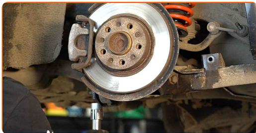
**68** Stram det bakre festelementet som forbinder det bakre styreleddet til bæreamen til opphenget. Bruk en pipenøkkelinnsats #21. Bruk en momentnøkkel. Stram den til 105 Nm dreiemoment.+45°
