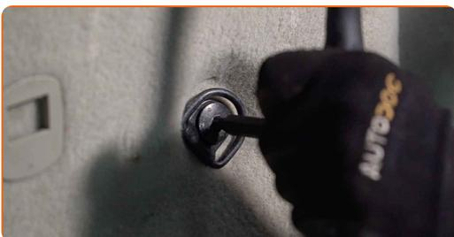
**84** Sett på dekselet til bagasjeromskledningen på siden.
