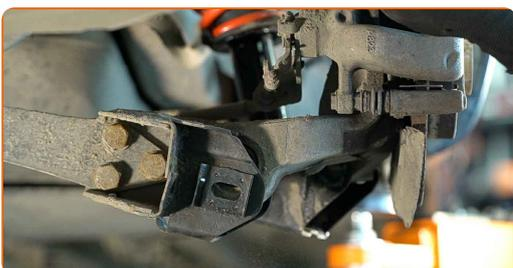
**62** Støtt armen. Bruk en hydraulisk jekk.
