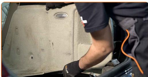
**17** Fjern sikkerhetsbelte list dekelet. Bruk en pipenøkkelinnsats #10. Bruk en skrallenøkkel.
