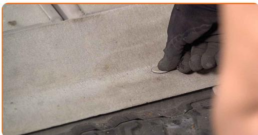
**91** Monter sikkerhetsbeltet list panelet. Bruk en pipenøkkelinnsats #10.
