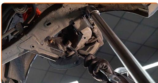
**67** Hev den hydrauliske girkassejekken 10 til 15 centimeter.
