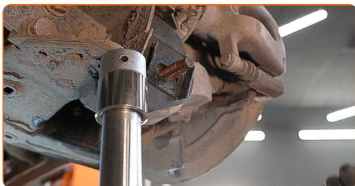
**64** Skru inn det bakre festeelementet som forbinder det bakre styreleddet til bæreamen til opphenget. Bruk en kombinasjonsnøkkel #22.
