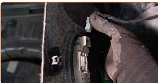
**83** Skru inn festet til bagasjeromskledningen på siden. Bruk Torx T25. Bruk en skrallenøkkel.
