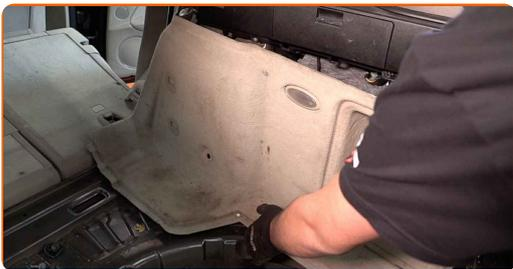
**82** Fest tilkoblingselementet til lyspæren. Fest klipsene til bagasjeromskledningen på siden.
