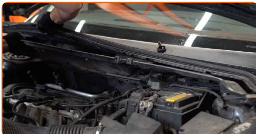
**11** Løsne det øverste festet på fjærbeinet montering. Bruk en pipenøkkelinnsats #13. Bruk en skrallenøkkel.
