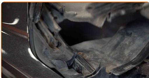
**9** Skru løst festene på det nederste plastdekselet mellom panser og frontrute. Bruk Torx T30. Bruk en skrallenøkkel.
