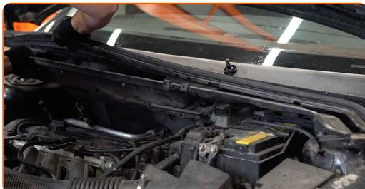
**11** Løsne det øverste festet på fjærbeinets montering. Bruk en pipenøkkelinnsats #13. Bruk en skrallenøkkel.
