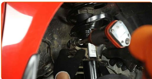
**53** Behandle festene til fjærbeinet. Behandle alle leddene på stabilisatorleddet. Bruk kobberfett.
