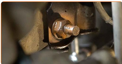
**54** Behandle overflaten hvor bremseskiven kontakter felgen. Bruk kobberfett.
