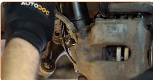
**12** Frigjør nedre feste som kobler fjærbein til styrespindel. Bruk en spesiell pipenøkkel til å fjerne støtdemperen.
