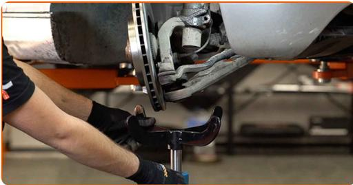
21 Frigjør nedre feste som kobler fjærbein til styrespindel. Bruk en spesiell pipenøkkel til å fjerne støtdemperen.
