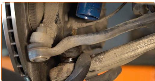
47 Koble den nedre armen til styrespindelen. Monter festene på kontrollarmen.
