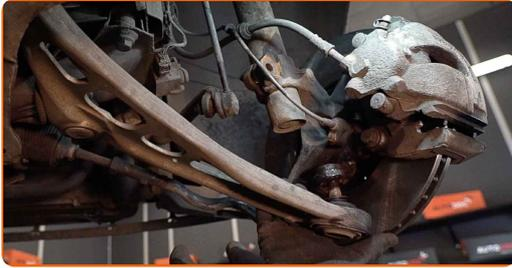
20 Løft opp styrespindelen. Bruk en hydraulisk jekk.
