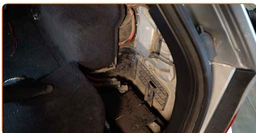
8 Skru løs festene til plast sidepanelet. Bruk Torx T25.
