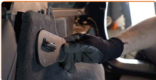
45 Skru fast de øvre festene til bagasjeroms ventilasjonspanel. Bruk en pipenøkkelinnsats #10. Bruk en skrallenøkkel.
