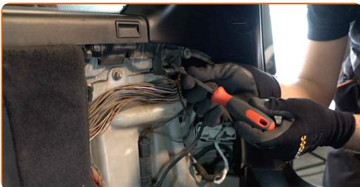
10 Skru løs festene til bagasjeroms framside panel. Bruk en Philips-skrutrekker.
