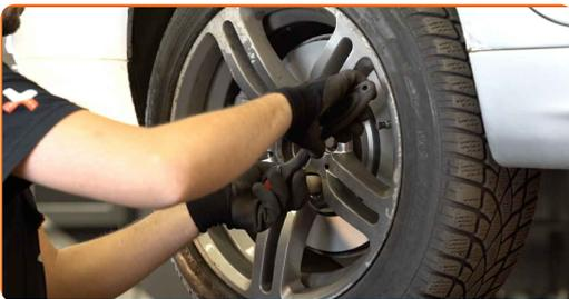
56 Senk bilen og stram hjulboltene, arbeid på kryss. Bruk en momentnøkkel. Stram den til 120 Nm dreiemoment.
