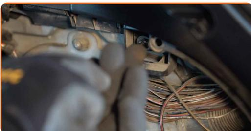
44 Monter plast klemmene til bagasjeroms framside panel.
