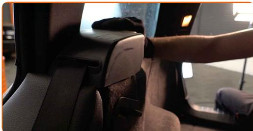
5 Ta bort plastklemmen til mansjettens frontside panel. Bruk et brekkjern.
