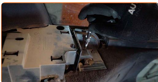
9.1 Skru løs festene til bagasjeroms ventilasjonspanel.
