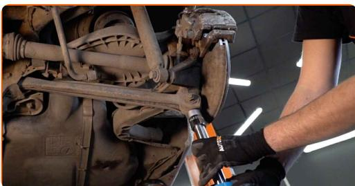
22 Rengjør festene til støtdemperen. Bruk en stålbørste. Bruk WD-40 spray.
