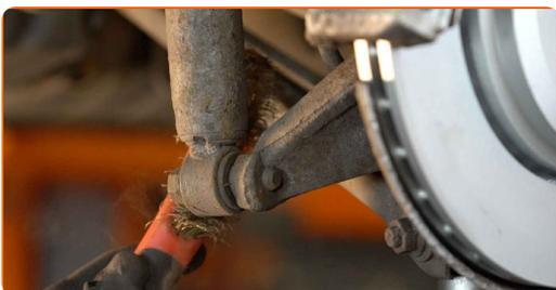
23 Skru fast det nedre festet på støtdemperen. Bruk en pipenøkkelinnsats #18. Bruk et svingjern.
