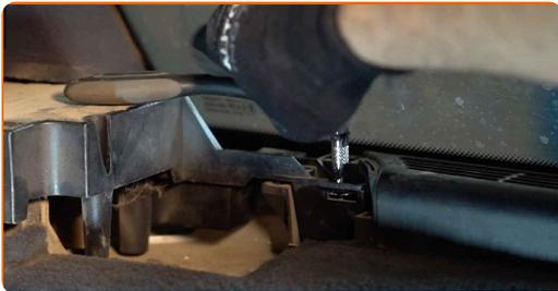
9.2 Bruk en pipenøkkelinnsats #10. Bruk en Philips-skrutrekker.
