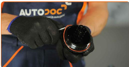
**16** Monter en ny O-ring på setet på filterdekslet. Bruk en flat skrutrekker.
