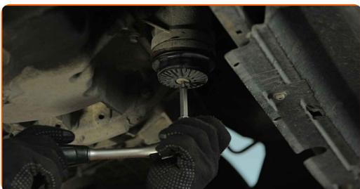
**4** Plasser en beholder for avfallsolje, med minst 5 l. kapasitet, under dreneringshullet.
