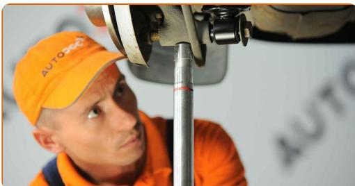
**34** Stram det nedre feste på støtdemperen. Bruk en kombinasjonsnøkkel #24. Bruk en pipenøkkelinnsats #24. Bruk en momentnøkkel. Stram den til 110 Nm dreiemoment.
