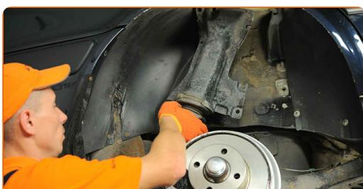
**31** Stram de øvre festene til fjærbeinet. Bruk en pipenøkkelinnsats #17. Bruk en momentnøkkel. Stram den til 55 Nm dreiemoment.
