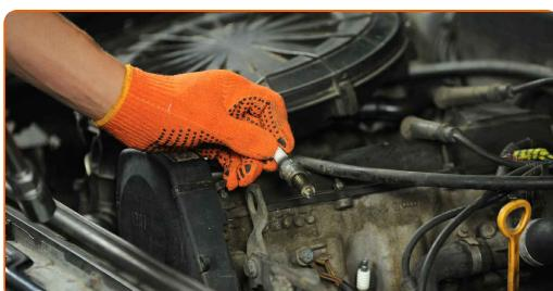
**7** Påfør et tynt lag med et spesielt høytemperaturfett på gjengene til de nye tennpluggene.
