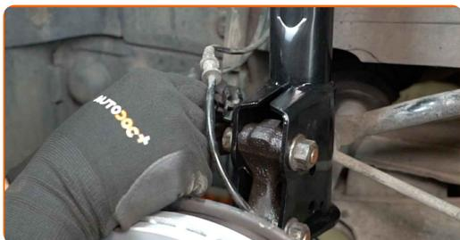
**48** Koble til kabelen til slitasjesensoren for bremseklosser.
