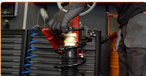
**34** Installer den øvre demperen og monteringslager.
