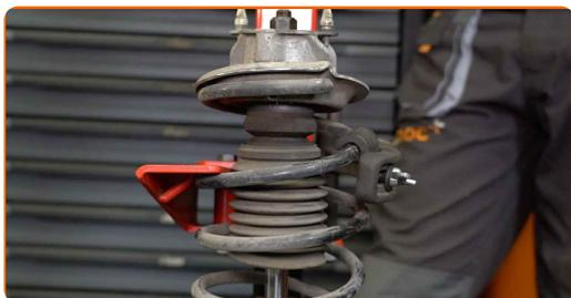
**24** Behandle stangen til fjærbeinet. Bruk en stålbørste. Bruk WD-40 spray.
