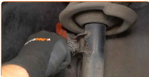
**11** Skru løs festene som kobler stabilisator-ledd til fjærbein. Bruk en pipenøkkelinnsats #16. Bruk en skrallenøkkel.
