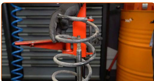
29 Ta vekk den gamle støtdemperen fra den hydrauliske kompressoren.
