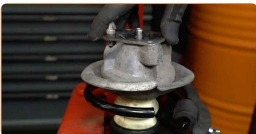
**35** Stram fjærbeinets stempelstangmutter. Bruk en pipenøkkelinnsats #21. Bruk HEX nr. H6. Bruk en momentnøkkel. Stram den til 60 Nm dreiemoment.
