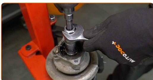
**26** Fjern støtdemperfestet, støvbeskytteren og støtstopperen.
