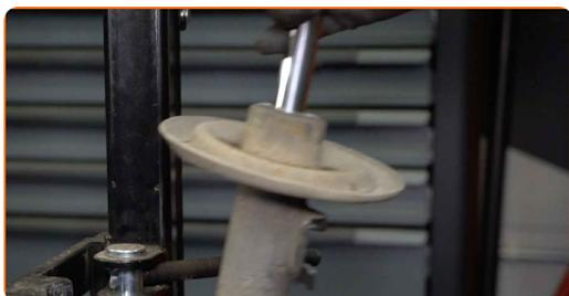
30 Installer den nye støtdemperen på den hydrauliske kompressoren til spiralfjæren.
