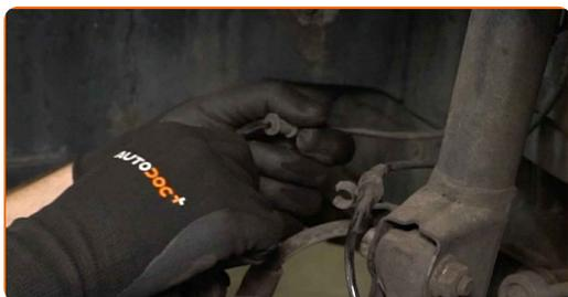
**14** Koble fra kabelen til slitasjesensoren for bremseklosser.
