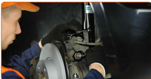
**53** Stram nedre fester som kobler fjærbein til styrespindel. Bruk en kombinasjonsnøkkel #21. Bruk en pipenøkkelinnsats #21. Bruk en momentnøkkel. Stram den til 120 Nm dreiemoment.+90°
