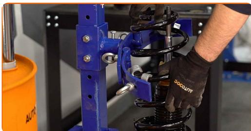
**36** Installer den øvre demperen og monteringslager.
