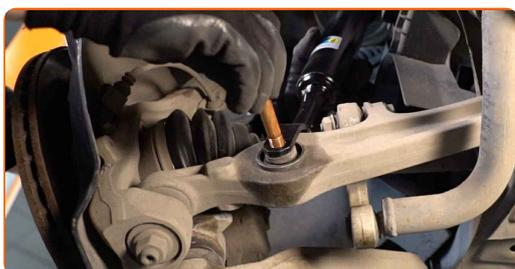
**44** Monter bæreamene. Bruk en gummihammer.
