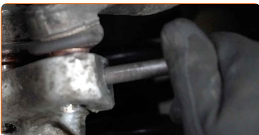
**11** Fjern bæreamene. Bruk en flat metal meisel. Bruk en hammer.
