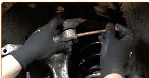
**46** Stram de øvre armfestene. Bruk en kombinasjonsnøkkel #17. Bruk en pipenøkkelinnsats #17. Bruk en momentnøkkel. Stram den til 40 Nm dreiemoment.
