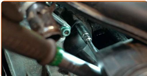
**36** Dokręć element mocujący przewód zasilania alternatora. Bruk en pipenøkkelinnsats #13. Bruk en momentnøkkel. Stram den til 5 Nm dreiemoment.
