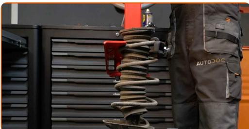
**30** Ta av støtdemper-støvhetten og støtstopperen.
