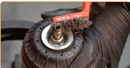
**27** Fjern mutteren på beinets stempelstang. Bruk HEX nr. H6. Bruk en pipenøkkelinnsats #18. Bruk en skrallenøkkel.
