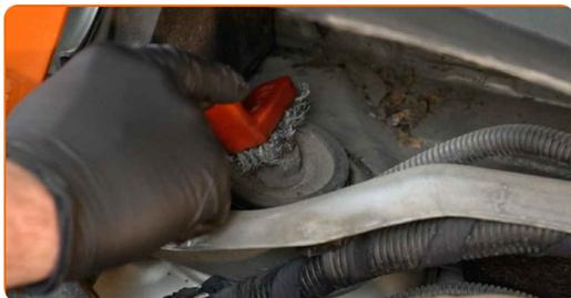
**8** Løsne det øverste festet på fjærbeinets montering. Bruk en kombinasjonsnøkkel #18. Bruk HEX nr. H6. Bruk en skrallenøkkel.
