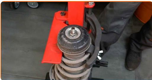
**26** Behandle stangen til fjærbeinet. Bruk en stålbørste. Bruk WD-40 spray.
