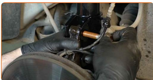
**47** Skru inn festet som forbinder fjærbeinet med styrespindelen. Bruk en kombinasjonsnøkkel #18. Bruk en pipenøkkelinnsats #18. Bruk en skrallenøkkel.
