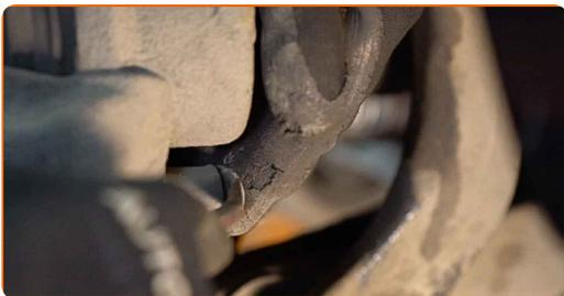
**8** Koble fra bremseklossens slitasjesensorplugg.
