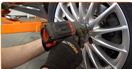
**28** Senk bilen og stram hjulboltene, arbeid på kryss. Bruk en momentnøkkel. Stram den til 120 Nm dreiemoment.
