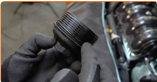
**19** Installer et nytt oljefilterhusdeksel og stram det. Bruk en pipenøkkelinnsats #36. Bruk en momentnøkkel. Stram den til 25 Nm dreiemoment.
