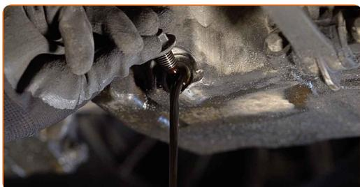
Utskifting: motorolje og oljefilter – ALFA ROMEO Brera (939). AUTODOCs eksperter anbefaler:
