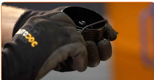
**16** Monter et nytt oljefilter på setet på filterdekslet.
