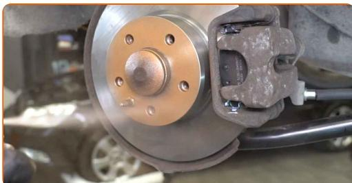
**21** Rengjør overflaten av bremseskiven. Bruk bremserens.
