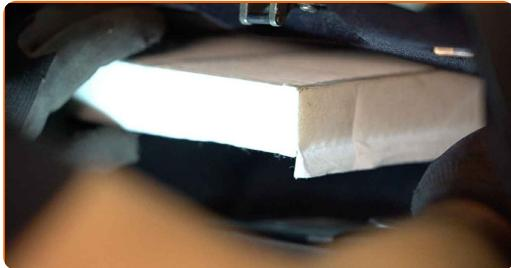
Utskifting: kupefilter – ALFA ROMEO SPIDER (939). AUTODOCs eksperter
