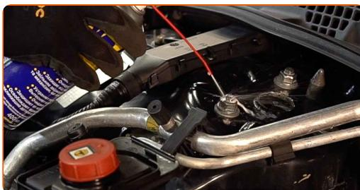
**4** Løsne det øverste festet på fjærbeinets montering. Bruk en pipenøkkelinnsats #16. Bruk en skrallenøkkel.
