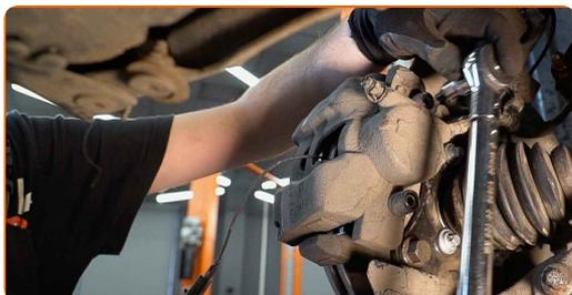
**52** Koble til bremseklossens slitasjesensorplugg.
