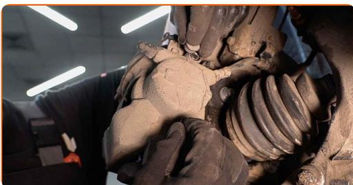
**54** Monter bremsekaliperens holderfjær. Bruk et brekkjern.
