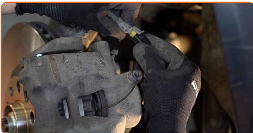
**53** Installer hetten til støvmansjetten på føringsstiftene i bremseklaven.
