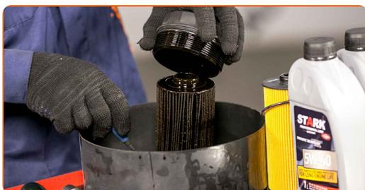
**8** Fjern O-ring til oljefilterdekslet. Bruk en flat skrutrekker.
