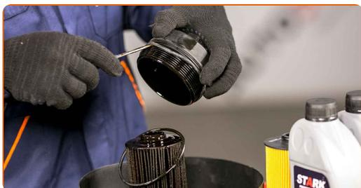
**11** Monter et nytt oljefilter på setet på filterdekslet.
