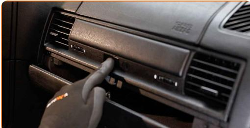
**3** Skru løs festeskuene på hanskerommet. Bruk en Philips-skrutrekker. Bruk en flat skrutrekker.
