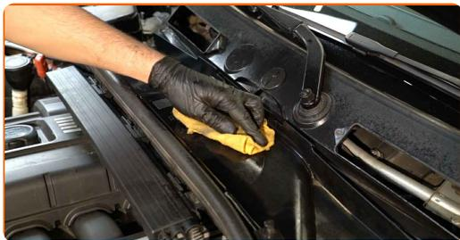
**10** Installer kupèfilterhusdekelet. Pass på at du hører et klikk som indikerer at den er låst på plass.
