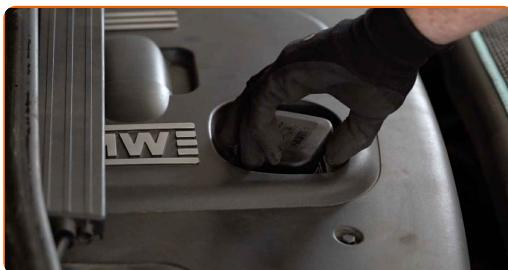
**4** Skru løs filterhushetten sammen med det gamle filterelementet. Bruk en pipenøkkelinnsats #36. Bruk en skrallenøkkel.
