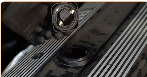
**4** Rengjør lokket til oljefilterhuset. Bruk universal rengjøringsspray.
