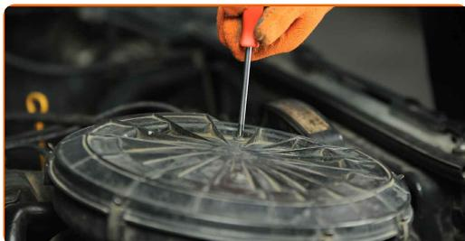
4 Løs klipsene til luftfilterdekselet.
