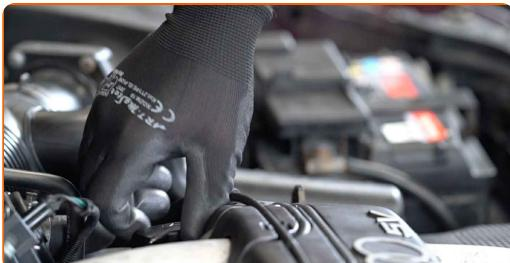
**5** Løsne festene på det nedre dekselet til oljepannen.
