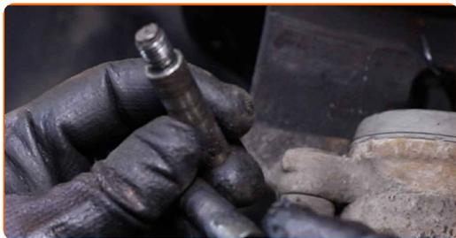
**15** Behandle bremsekaliper styrepinnene. Bruk bremserens.
