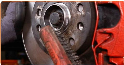
**26** Behandle overflaten hvor bremseskiven kontakter felgen. Bruk keramisk pasta.
