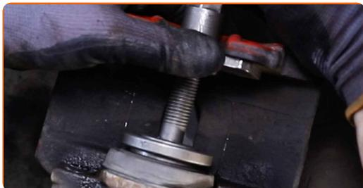
**18** Monter styrepinnene til bremsekaliperen.
