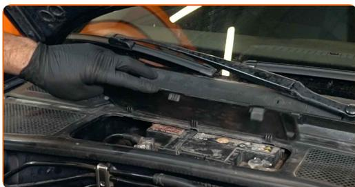
19 Skru løs festene til polklemmene til batteriet. Bruk en kombinasjonsnøkkel #10.
