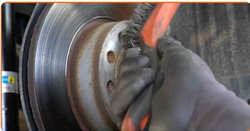
**47** Behandle overflaten hvor bremseskiven kontakter felgen. Bruk keramisk pasta.
