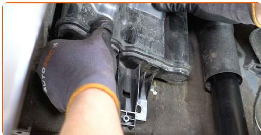
**39** Stram festene til beholderen med det aktive kullet. Bruk en pipenøkkelinnsats #13. Bruk en momentnøkkel. Stram den til 12 Nm dreiemoment.
