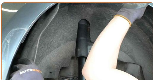
**42** Skru inn festene til hjulbuedekselet. Bruk Torx T25. Bruk en skrallenøkkel.
