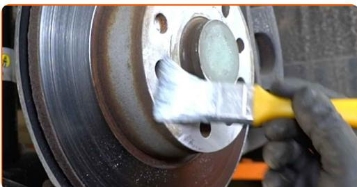
**48** Rengjør overflaten av bremseskiven. Bruk bremsrens.
