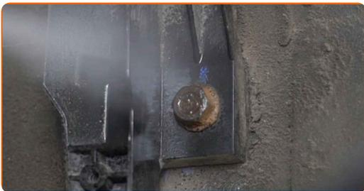
**13** Skru løs festene til beholderen med det aktive kullet. Bruk en pipenøkkelinnsats #13. Bruk en skrallenøkkel.
