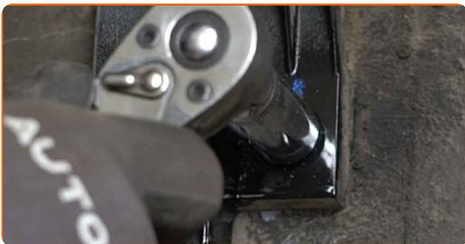
**14** Flytt beholderen med det aktive kullet til sides for å nå de øvre festene til støtdemperen.
