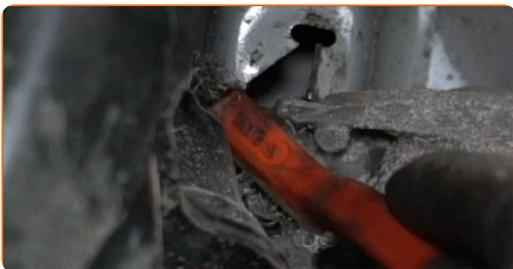
**16** Skru løs festene til støtdemperfestet. Bruk en pipenøkkelinnsats #16. Bruk en skrallenøkkel.
