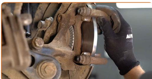
**30** Stram bremsekalipperbraketten. Bruk HEX nr. H8. Bruk en momentnøkkel. Stram den til 75 Nm dreiemoment.
