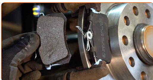
**34** Installer bremsekaliperen og fest den. Bruk en pipenøkkelinnsett #13. Bruk en kombinasjonsnøkkel #15. Bruk en momentnøkkel. Stram den til 35 Nm dreiemoment.
