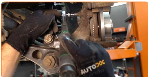
**31** Behandle stempelet til bremsekaliperen. Bruk bremserens.
