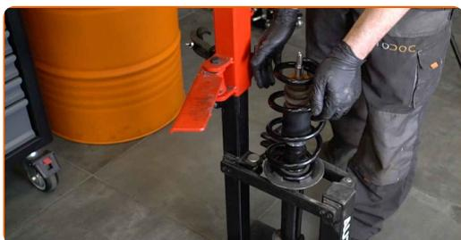
**58** Installer den øvre demperen og monteringslager.
