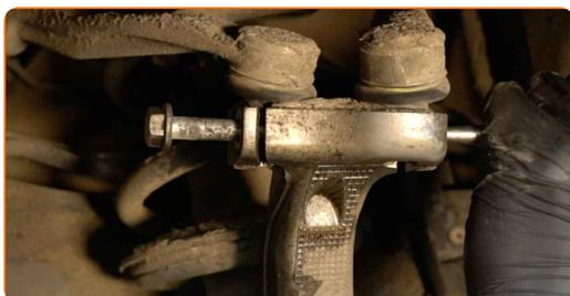
**29** Fjern den øvre bæreammen fra rattspindelen. Bruk et brekkjern.
