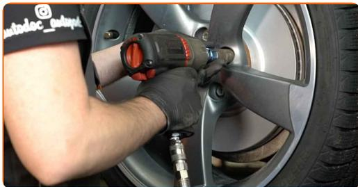
**104** Senk bilen og stram hjulboltene, arbeid på kryss. Bruk en kraftpipe for hjulmutter #17. Bruk en momentnøkkel. Stram den til 120 Nm dreiemoment.
