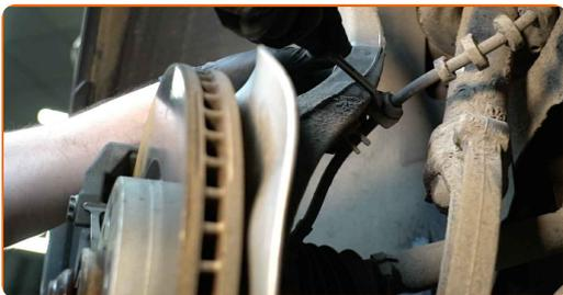
**32** Rengjør festene til bremsecaliperen. Bruk en stålbørste. Bruk WD-40 spray.
