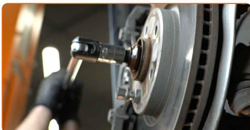
**24** Løsne festebolten som forbinder gaffelen til støttemperen med den nedre bæreamen. Bruk en kombinasjonsnøkkel #18. Bruk en pipenøkkelinnsats #18. Bruk en skrallenøkkel.
