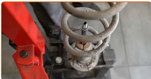
**55** Ta av støtdemper-støvhetten og støtstopperen.
