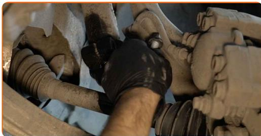
**22** Rengjør boltene til hjulnavet. Bruk en stålbørste. Bruk WD-40 spray.
