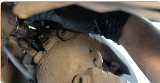
**34** Spre bremseklossene. Bruk et brekkjern.
