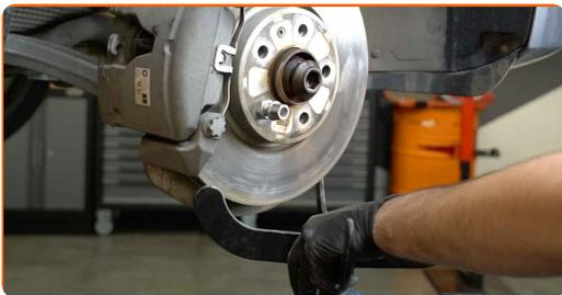
**31** Koble fra bremseslangen. Bruk et brekkjern.
