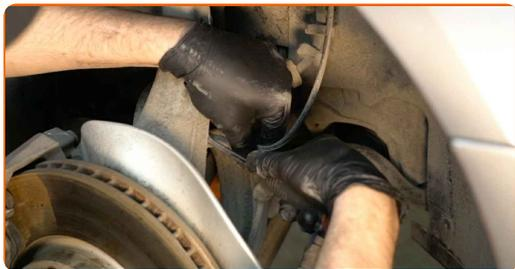
**26** Rengjør koplingsstykket til ABS-sensoren. Bruk en rengjøringsbørste av nylon. Bruk WD-40 spray.
