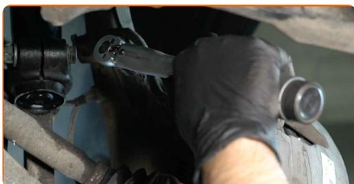
**19** Monter bremsekaliperens holderfjær.
