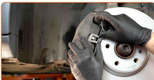
**20** Behandle overflaten hvor bremsekiven kontakter felgen. Bruk kobberfett.
