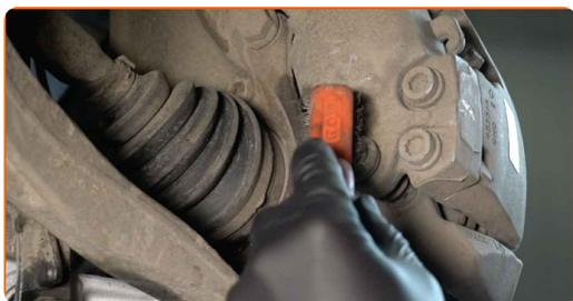
**8** Skru løs bremsekalippernes feste. Bruk en pipenøkkelinnsats #13. Bruk en skrallenøkkel.
