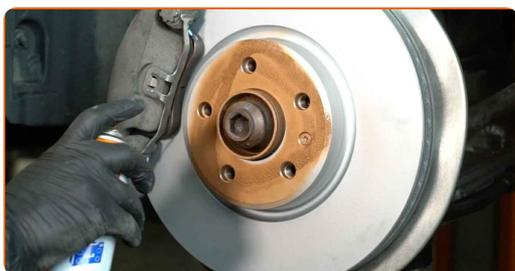
**21** Rengjør overflaten av bremsekiven. Bruk bremserens.
