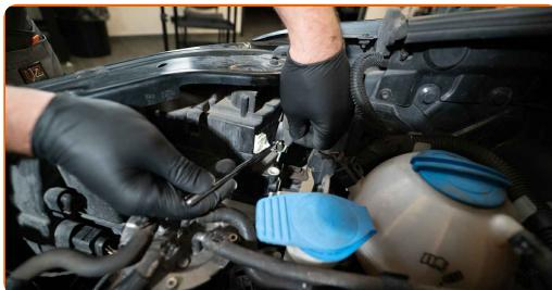
**3** Koble fra lyspære sokkelen ved å vri den 30°. Fjern holderen fra frontlyktens monteringsfeste.
