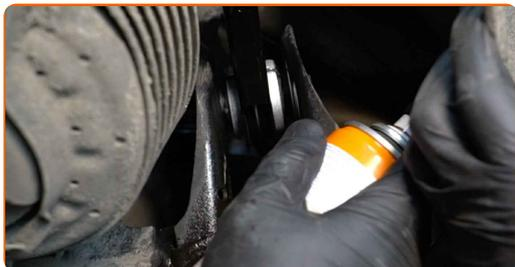
**20** Stram festet som kobler multilink-bæreamen til bakre akseltapp. Bruk en pipenøkkelinnsats #18. Bruk en momentnøkkel. Stram den til 95 Nm dreiemoment.
