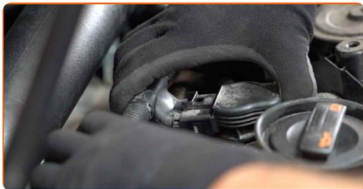
**13** Monter motordekselet og fest det. Pass på at du hører et klikk som indikerer at den er låst på plass.
