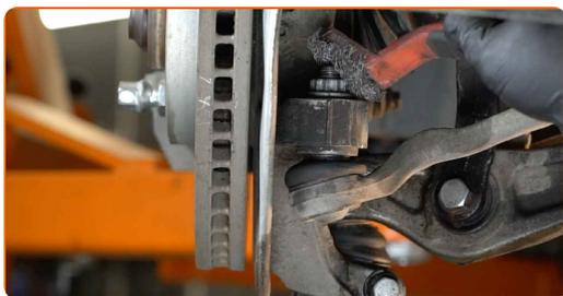
**7** Skru endefestemutteren fast til styrespindelen. Bruk en kombinasjonsnøkkel #21.
