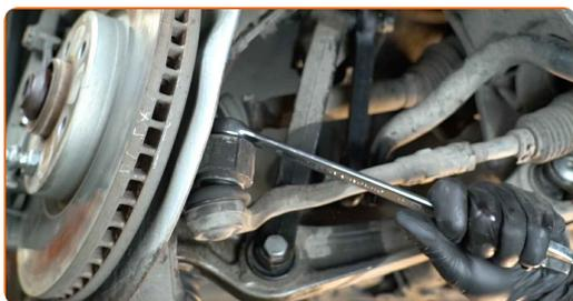
**8** Rengjør låsemutteren som kobler styrestaget til endeledet. Bruk en stålbørste. Bruk WD-40 spray.
