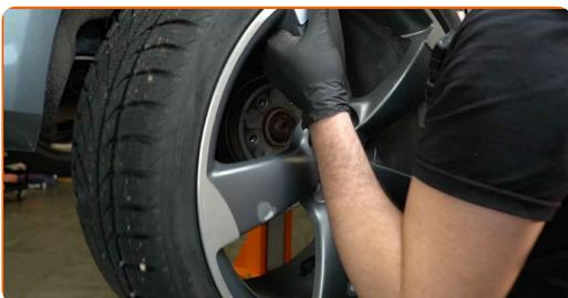
**8** Rengjør festene til bremsecaliperen. Bruk en stålbørste. Bruk WD-40 spray.
