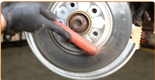
**17** Skru løs bremseskivefestet. Bruk Torx T30. Bruk en slagskrutrekker.
