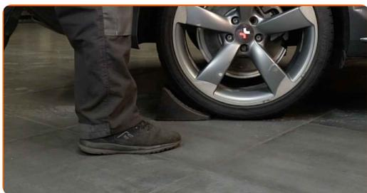
**4** Løsne hjulfesteboltene. Bruk en kraftpipe for hjulmutter #17.
