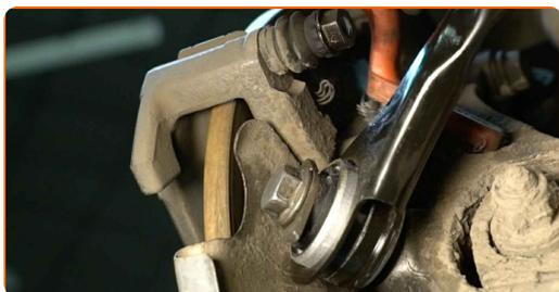
**14** Skru løs kalipperbrakettfestet. Bruk en kombinasjonsnøkkel #18.
