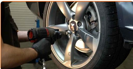
**35** Senk bilen og stram hjulboltene, arbeid på kryss. Bruk en kraftpipe for hjulmutter #17. Bruk en momentnøkkel. Stram den til 120 Nm dreiemoment.
