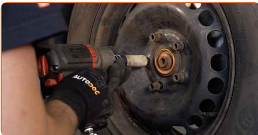
**19** Senk bilen og stram hjulboltene, arbeid på kryss. Bruk en momentnøkkel. Stram den til 120 Nm dreiemoment.
