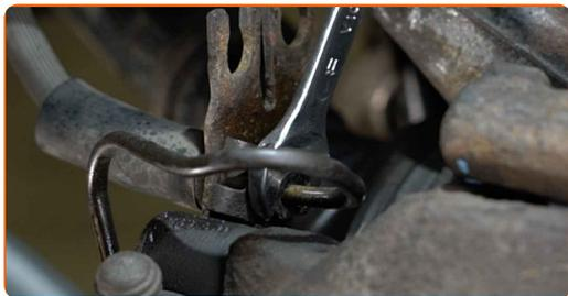
**14** Fjern hetten til støvmansjetten på føringsstiftene i bremseklaven. Bruk et brekkjern.
