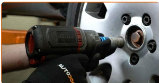
**46** Senk bilen og stram hjulboltene, arbeid på kryss. Bruk en kraftpipe for hjulmutter #17. Bruk en momentnøkkel. Stram den til 120 Nm dreiemoment.
