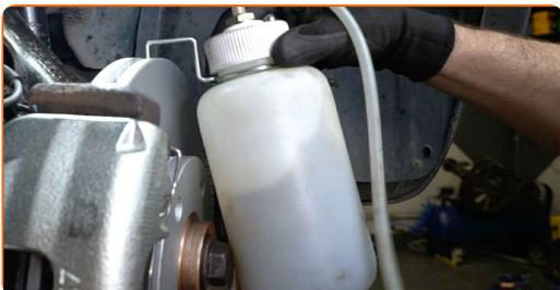
**36** Løsne lufteskruen til bremsen. Bruk en kombinasjonsnøkkel #10.
