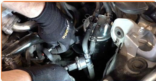
**18** Stram festeklemmen til drivstoffilterrøret. Bruk en clic-R-slangeklemmetang.
