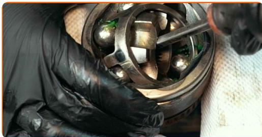
**33** Zwolnij szczęki imadła i wyjmij przegub napędowy półosi.
