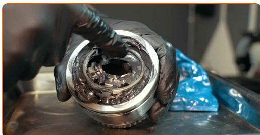
**35** Przesuń bieżnię wewnętrzną przegubu napędowego półosi z boku na bok, aby go dotrzeć.
