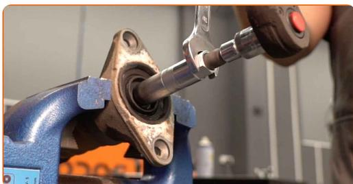
**19** Fjern støtdemperfestet, støvbeskytteren og støtstopperen.
