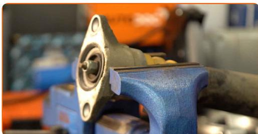
**17** Rengjør festene til støtdemperstangen. Bruk en stålbørste. Bruk WD-40 spray.
