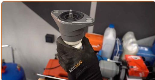
**21** Skru fast det øvre festet på fjærbeinets stempelstang. Bruk en kombinasjonsnøkkel #17. Bruk en låsetang. Bruk en momentnøkkel. Stram den til 25 Nm dreiemoment.
