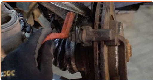
**14** Skru løs kalipperbrakettfestet. Bruk en pipenøkkelinnsats #21. Bruk en skrallenøkkel. Bruk et svingjern.
