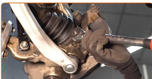
**24** Behandle stempelet til bremsekaliperen. Bruk bremserens.
