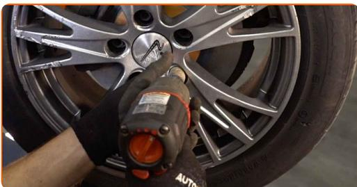
**33** Senk bilen og stram hjulboltene, arbeid på kryss. Bruk en momentnøkkel. Stram den til 120 Nm dreiemoment.
